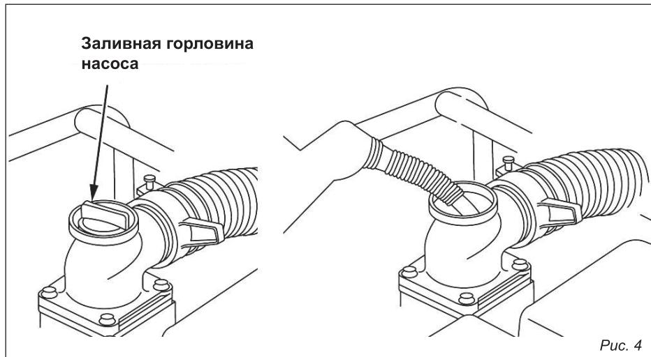
■ Выход насосной части из строя по причине неправильной эксплуатации и не соблюдения предписаний технического обслуживания, является нарушением условий гарантийного обслуживания. К безусловным признакам неверного ввода в эксплуатацию, работы насоса без заливки водой, работы насоса «в сухую» без воды, является: появление цветов побежалости, деформация, разрушение/заклинивание или оплавление лопастного колеса и иных узлов изделия, разрушение резиновых уплотнителей.
