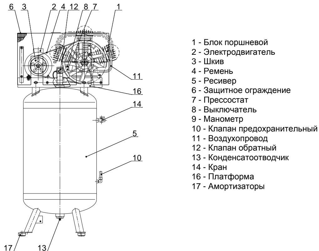
Рисунок 9 - Общий вид компрессора СБ4/Ф-270.ЛВ40В
