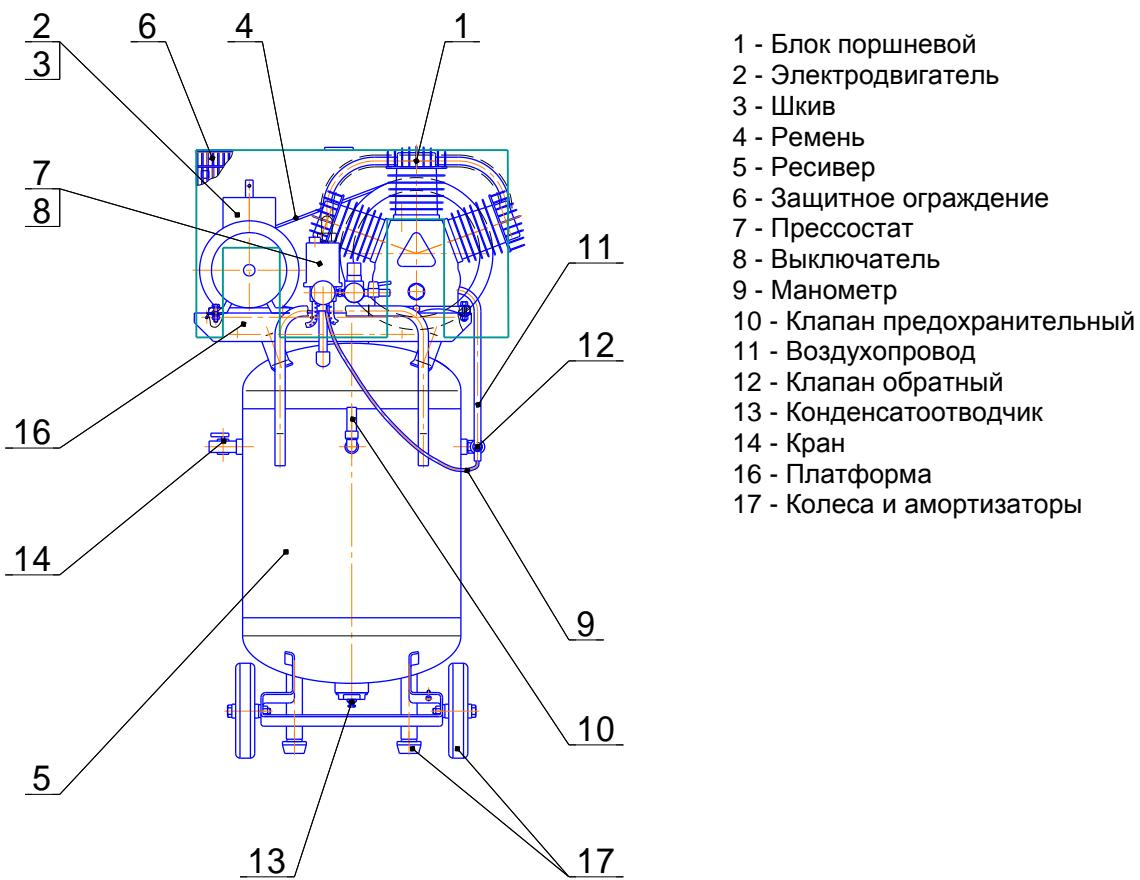
Рисунок 7 - Общий вид компрессора СБ4/C-100.LB40B
