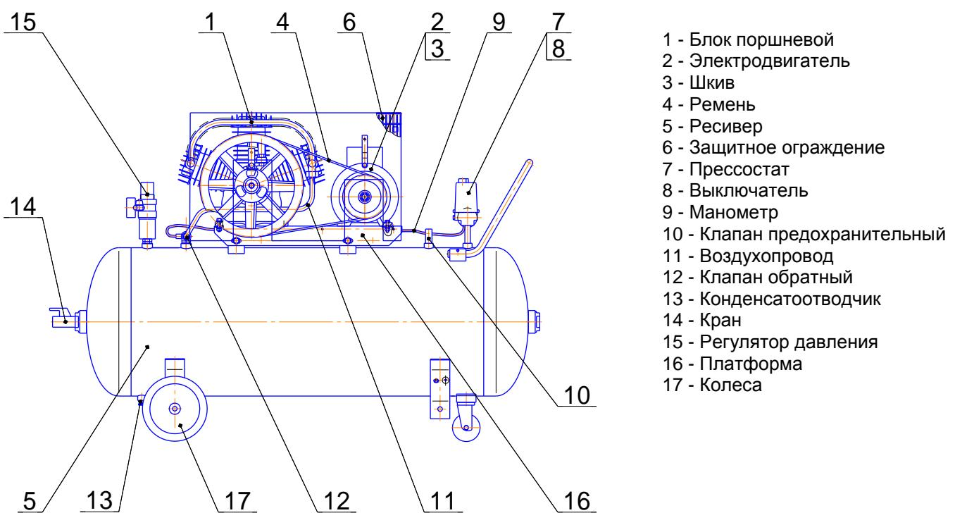
Рисунок 8 - Общий вид компрессора СБ4/C-200.LB40
